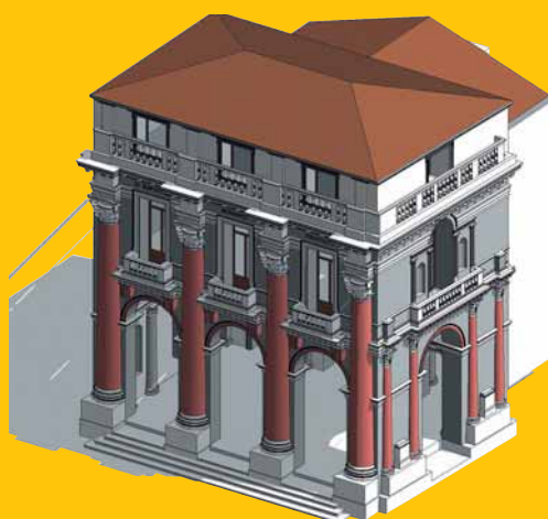
Vista prospettica e assonometria ombreggiata della Loggia del Capitanato di Andrea Palladio a Vicenza, ricostruita integralmente in ambito BIM dall'arch. Simone Cappochin per studiare il manufatto. Grande attenzione è stata posta alla modellazione parametrica tridimensionale in grado di restituire con estrema fedeltà tutti gli elementi architettonici dell'opera palladiana. Colonne, capitelli, fusi e balaustre sono stati riprodotti a partire dal rilievo e dai disegni originali del Palladio della Loggia del Capitanato. La ricostruzione tridimensionale di un modello complesso permette di poterlo analizzare e rappresentare in infinite viste.
